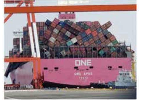
Şekil 2- Parametrik yalpa rezonansı sonrası kazaya uğrayan ONE APUS gemisinin, kaza sonrası görüntüsü[14]
