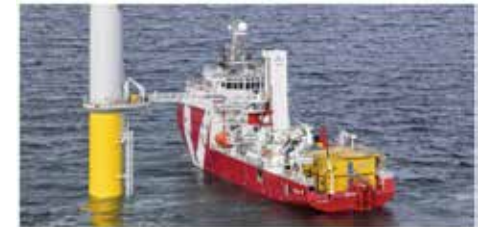
Şekil 7: Rüzgar Türbini Destek Gemisi için geliştirilmiş hareket sönümlenme sistemleri (Kaynak: http://www.shipandoffshore.net )
