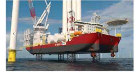
Şekil 5: ADRT yerleştirme gemisi (Kaynak: https://www.workboat.com/wind/industry-report-offshore-wind-needs-more-installation-vessels-asap )
