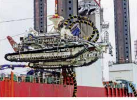
Şekil 8: Deniz dibi kablo gemilerinde kullanılan ve deniz tabanının 4 m. derinliğine kablo gömen traktör (Kaynak: http://ocean-energyresources.com/ )
