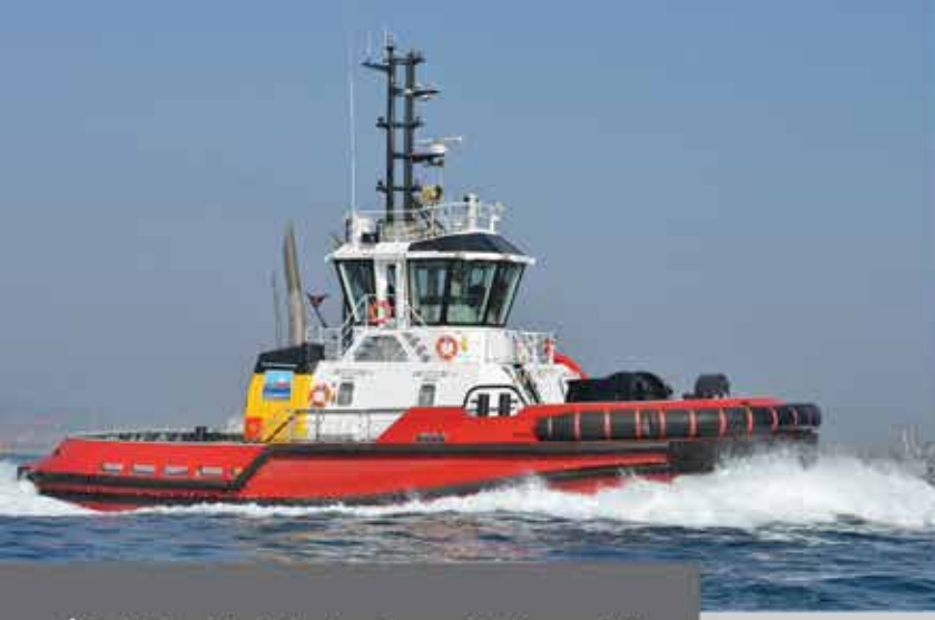
İlk hidrolik hibrit sistemli römorkör
