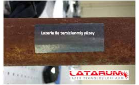
Şekil 5. Metal yüzeyinden lazer ile pas sökme işlemi.
