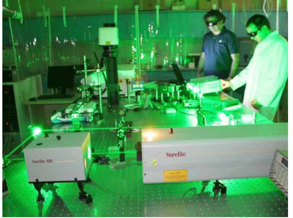
Şekil 9. Lazerle metal yüzeyinde su sevmeyen yüzey oluşturma ve freze izlerini yok etme işlemi [9].
