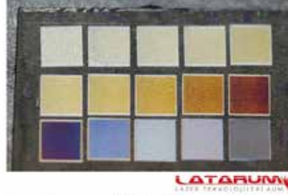
Şekil 8. Metal yüzeyinin lazer ile renklendirilmesi.
