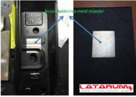
Şekil 6. Metal yüzeylerde lazerle boya kaldırma işlemi.
