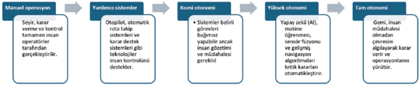
Şekil 1 Gemiler için otonom teknoloji seviyeleri
