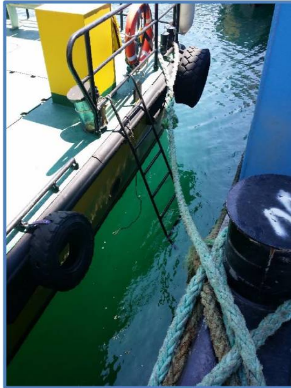
Resim 6: Kılavuz teknesinden indirilen parampet merdivenin görüntüsü
