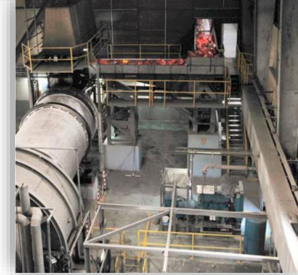
Tesis Kapasitesi: Tıbbi Atık Yakma Tesisi 24 ton/gün 1200 °C
